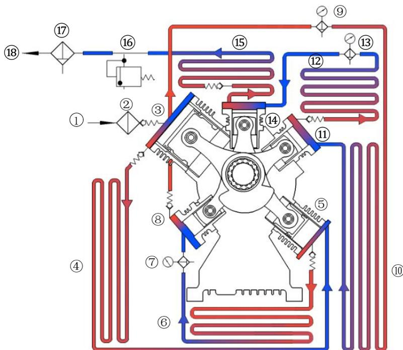
空气经①空气过滤器过滤后经②一级气缸进气阀进入一级气缸压缩到 4BAR 的压力。经一级气缸压缩后，从③一级气缸排气阀进入④一级冷凝管，冷却后的气体进入二级气缸再次增压到 16BAR。压缩后的气体通过⑤二级气缸排气阀进入⑥二级冷凝管，经⑦油水分离器处理后，通过三级进气阀进入三级气缸，将空气压缩至 65BAR。从⑧三级气缸出气阀进入三级冷凝管，经⑨油水分离器处理后，通过⑩三级冷凝管，进入四级气缸，将空气压缩至 350BAR，经四级气缸压缩后的气体通过⑪四级气缸排气阀进入⑫四级冷凝管，经⑬油水分离器处理后，然后进入⑭五级气缸讲空气压缩到 500BAR，经五级气缸压缩后的气体通过⑮五级冷凝管，最后到达⑰活性炭分子筛过滤器，过滤后的纯净空气经⑱连接管排出。
